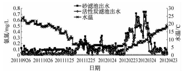
图4 水温与深度处理氨氮的关系(中桥水厂)
